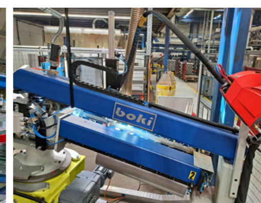
Neue automatische Mantelschweißanlage (Frauenthal Airtank Elterlein)
