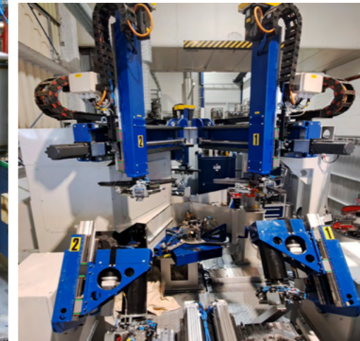
Neue Laserschweißtechnik für Bodenfertigung (Frauenthal Airtank Elterlein)
