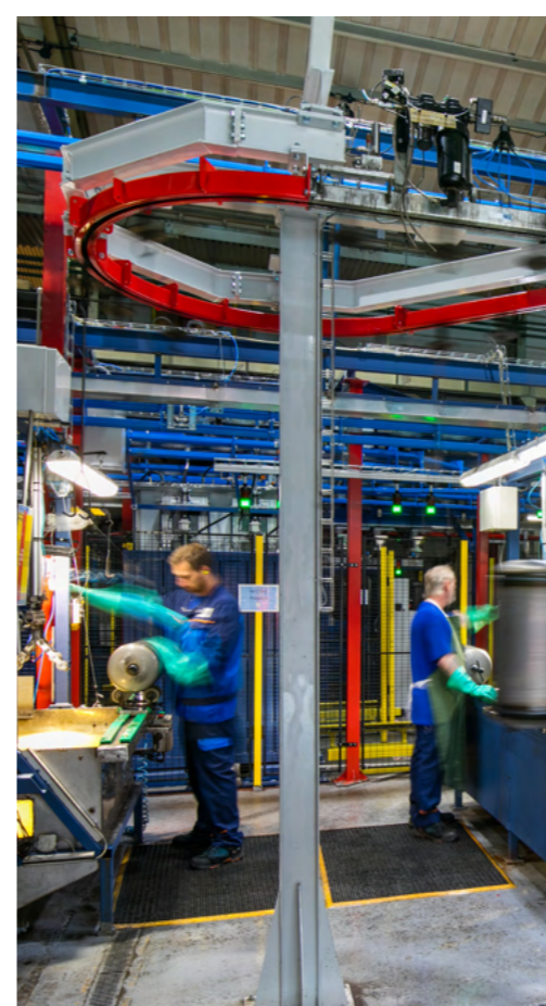
Dichtheitsprüfung an der neuen Power&Free-Anlage (Frauenthal Airtank Hustopece)
